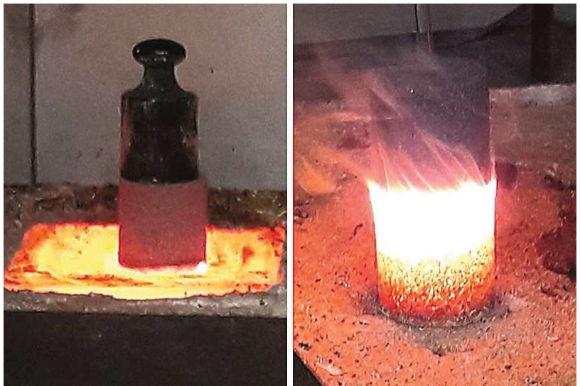
Bild 1: Versuchsaufbau zur Untersuchung des Brennverhaltens exothermer Speisermassen.
